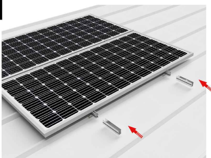
Kit 1 - Colocar las uniones (x2) suministradas en el Kit de unión en los perfiles guía del kit 1
