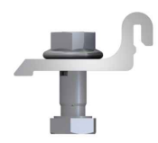
Ejemplo de montaje sobre perfil G6
